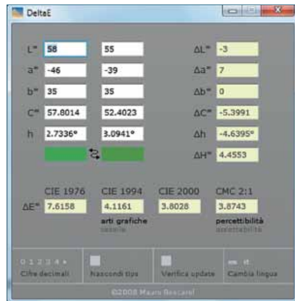
Figg. 12-14 Immagini da un'applicazione, il Delta Air, sviluppata dal Dr. Mauro Boscarol per calcolare le differenze di colore secondo vari sistemi. Una volta inseriti i valori L^*a^*b^* dei due campioni, in basso appaiono i diversi \Delta E . Si notino le differenze tra il jpeg on-camera e quello ottenuto con profilo specifico di fotocamera e sviluppo in Camera raw.
