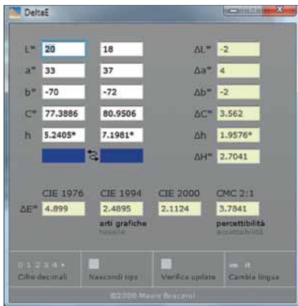
Figg. 18-20 I \Delta E relativi a due jpeg sviluppati da raw con profilo specifico in Camera raw. Le immagini sono state ottenute da due fotocamere diverse. Le differenze di colore sono minime, a dimostrazione dell'efficacia delle procedure di gestione del colore. La convinzione diffusa che marche diverse di fotocamere rendano colori diversi, non è quindi fondata, ma anzi del tutto erranea.
