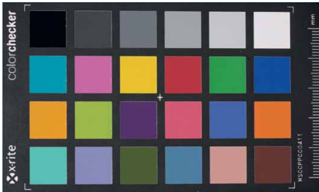
Fig. 7 Un target per la creazione di un profilo di fotocamera: il Color Checker della X-Rite; i valori colorimetrici L^*a^*b^* e XYZ delle tacche sono noti e disponibili presso il sito del produttore.
