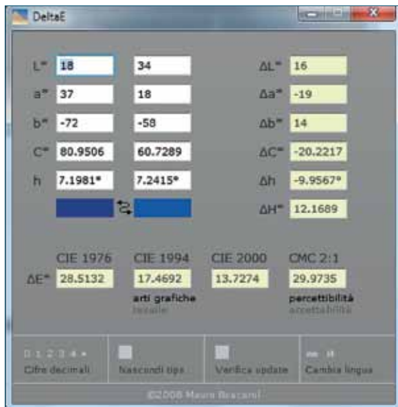
Figg. 12-14 Immagini da un'applicazione, il Delta Air, sviluppata dal Dr. Mauro Boscarol per calcolare le differenze di colore secondo vari sistemi. Una volta inseriti i valori L^*a^*b^* dei due campioni, in basso appaiono i diversi \Delta E . Si notino le differenze tra il jpeg on-camera e quello ottenuto con profilo specifico di fotocamera e sviluppo in Camera raw.
