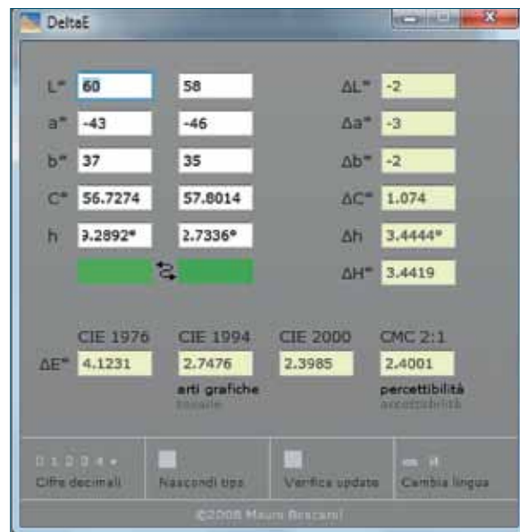
Figg. 18-20 I \Delta E relativi a due jpeg sviluppati da raw con profilo specifico in Camera raw. Le immagini sono state ottenute da due fotocamere diverse. Le differenze di colore sono minime, a dimostrazione dell'efficacia delle procedure di gestione del colore. La convinzione diffusa che marche diverse di fotocamere rendano colori diversi, non è quindi fondata, ma anzi del tutto erranea.
