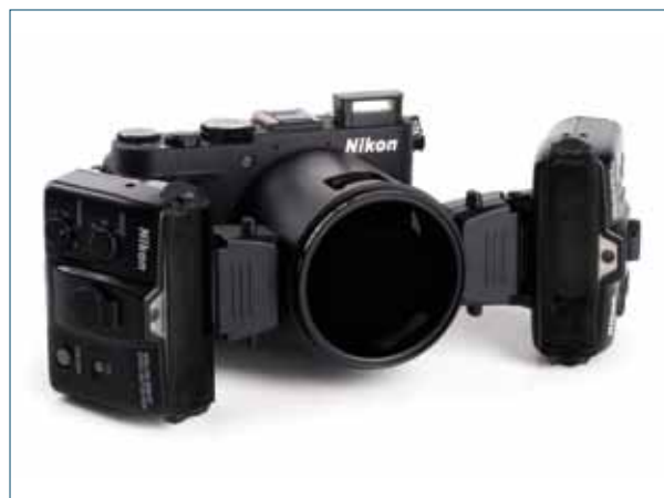
Figg. 27,28 Polarizzazione incrociata Nital montata in soluzione Spider su Reflex DSLR e su Coolpix P7700.
