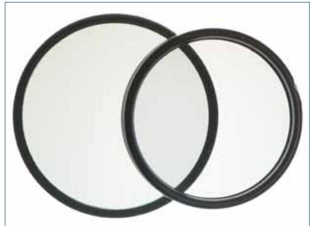
Fig. 8 Un esempio reale di polarizzazione coerente: i due filtri nella zona di sovrapposizione lasciano completamente passare la luce. Il primo filtro ha polarizzato linearmente e il secondo, con le griglie molecolari disposte in modo coerente, non ha interferito.
