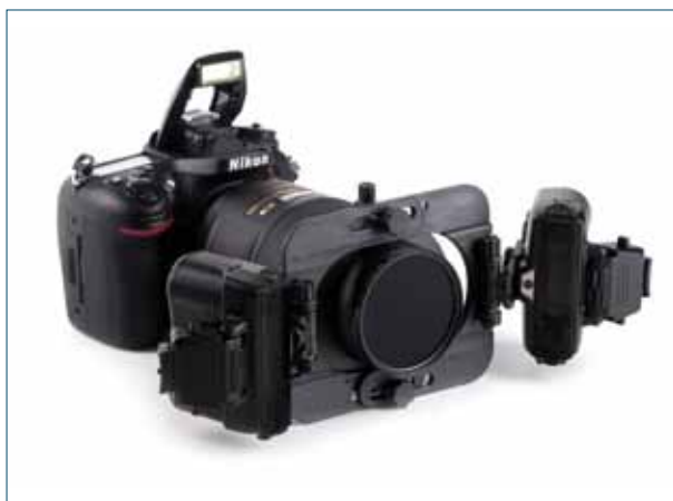
Figg. 27,28 Polarizzazione incrociata Nital montata in soluzione Spider su Reflex DSLR e su Coolpix P7700.
