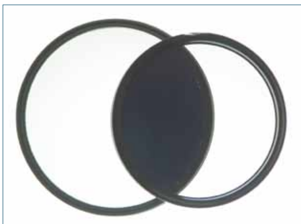
Fig. 10 In questo caso i due filtri hanno una zona di sovrapposizione nella quale le griglie sono orientate ortogonalmente cioè incrociate, e ciò comporta la completa estinzione della radiazione luminosa.
